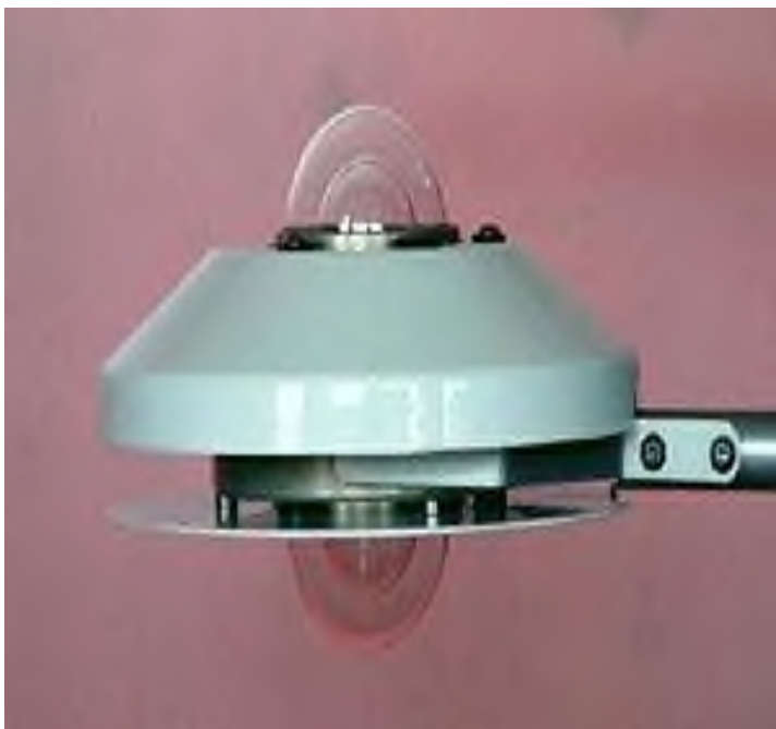
Альбедометр — прибор для измерения альбедо.
