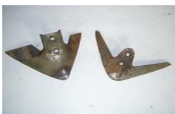
Рис. 1.3. Износ носовой части стрелчатых лап
