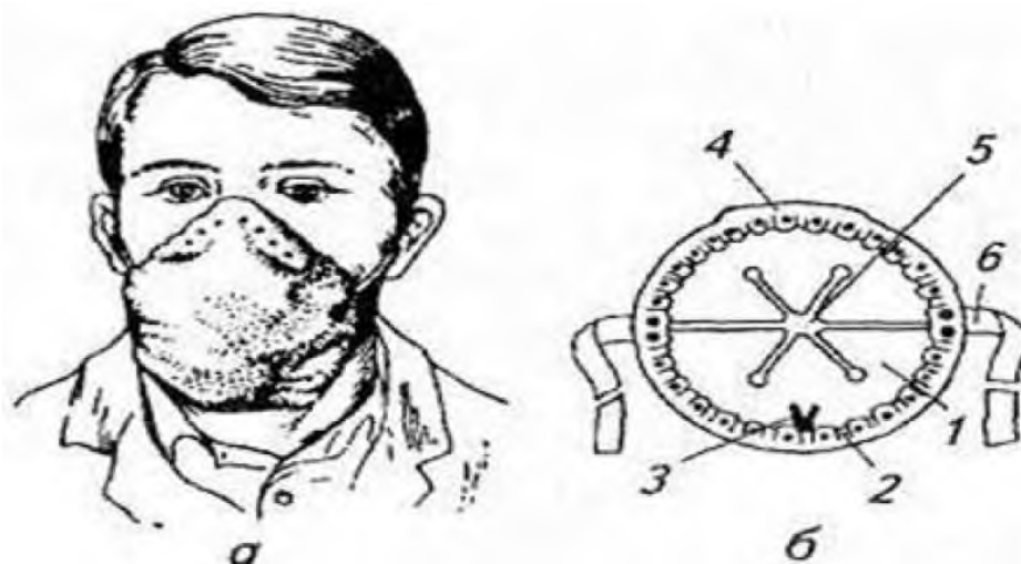
Рисунок 1.3. Респиратор типа «Лепесток - ШБ1»
